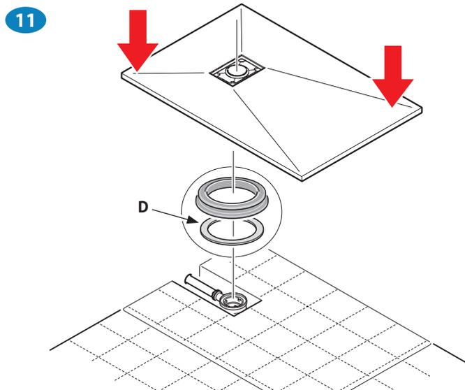
Se necessario utilizzare anche l'anello distanziale "D" per garantire la corretta stabilità e tenuta della piletta.
